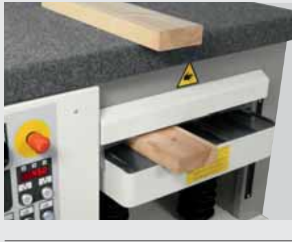
Anti-scratching carpet-lined top for a handy support surface. Eine praktische Abstellfläche durch die Teppichverkleidung.
