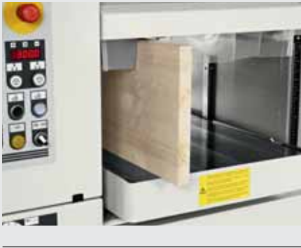
Maximum working height 300 mm! Maximale Betriebshöhe beim Hobeln 300 mm!
